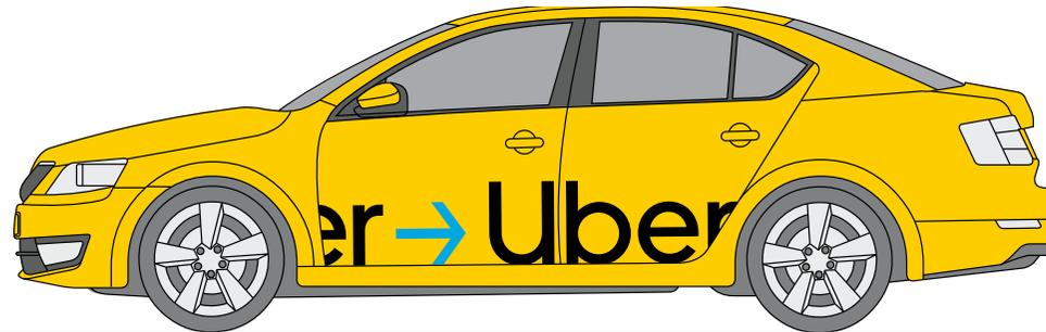
Разместите номер, логотип и шашечки по базовой линии. Не ставьте эти элементы ближе чем на 100 мм к краю двери и ближе чем 50 мм к нижней кромке окна. Наклейка «Партнёр сервиса Uber» располагается над задним пассажирским стеклом. На расстоянии 50 мм от кромок окна.
