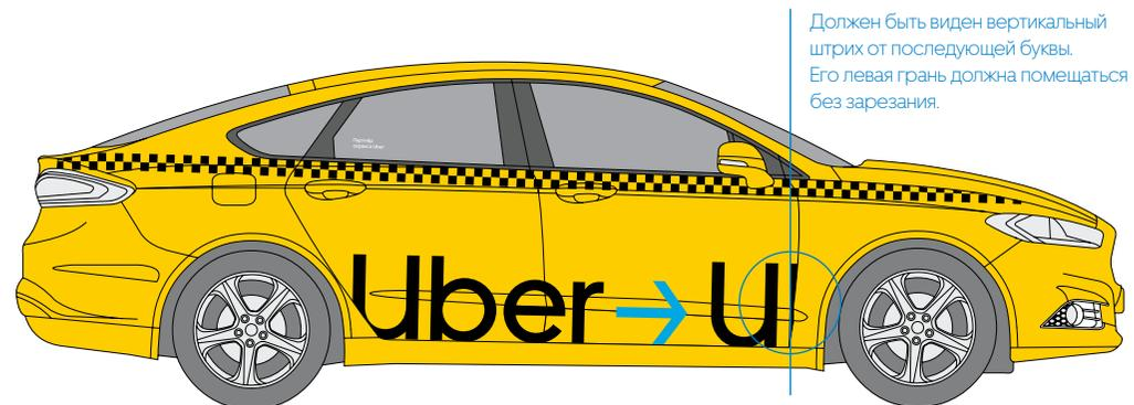
Разместите номер и логотип по базовой линии. Не ставьте эти элементы ближе чем на 100 мм к краю двери и на расстоянии 30-50 мм от нижней кромки окна. Наклейка «Партнёр сервиса Uber» располагается над задним пассажирским стеклом. На расстоянии 50 мм от кромок окна.
