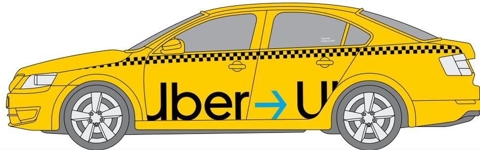
Разместите номер и логотип по базовой линии. Не ставьте эти элементы ближе чем на 100 мм к краю двери и на расстоянии 30-50 мм от нижней кромки окна. Наклейка «Партнёр сервиса Uber» располагается над задним пассажирским стеклом. На расстоянии 50 мм от кромок окна.
