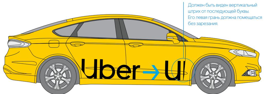
Разместите номер, логотип и шашечки по базовой линии. Не ставьте эти элементы ближе чем на 100 мм к краю двери и ближе чем 50 мм к нижней кромке окна. Наклейка «Партнёр сервиса Uber» располагается над задним пассажирским стеклом. На расстоянии 50 мм от кромок окна.
