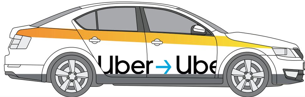
Разместите номер, логотип и шашечки по базовой линии параллельной нижней кромке окна по центру жёлтой светоотражающей полосы по вертикали. Не ставьте эти элементы ближе чем на 100 мм к краю двери. Наклейка «Партнёр сервиса Uber» располагается над задним пассажирским стеклом. На расстоянии 50 мм от кромок окна.
